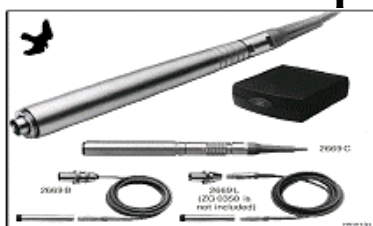
Микрофонный усилитель типа 2669(1/2") 2669B - интегрированный кабель с разъемом B&K 2669L - интегрированный кабель с разъемом LEMO Частотный диапазон 3Гц - 200кГц
