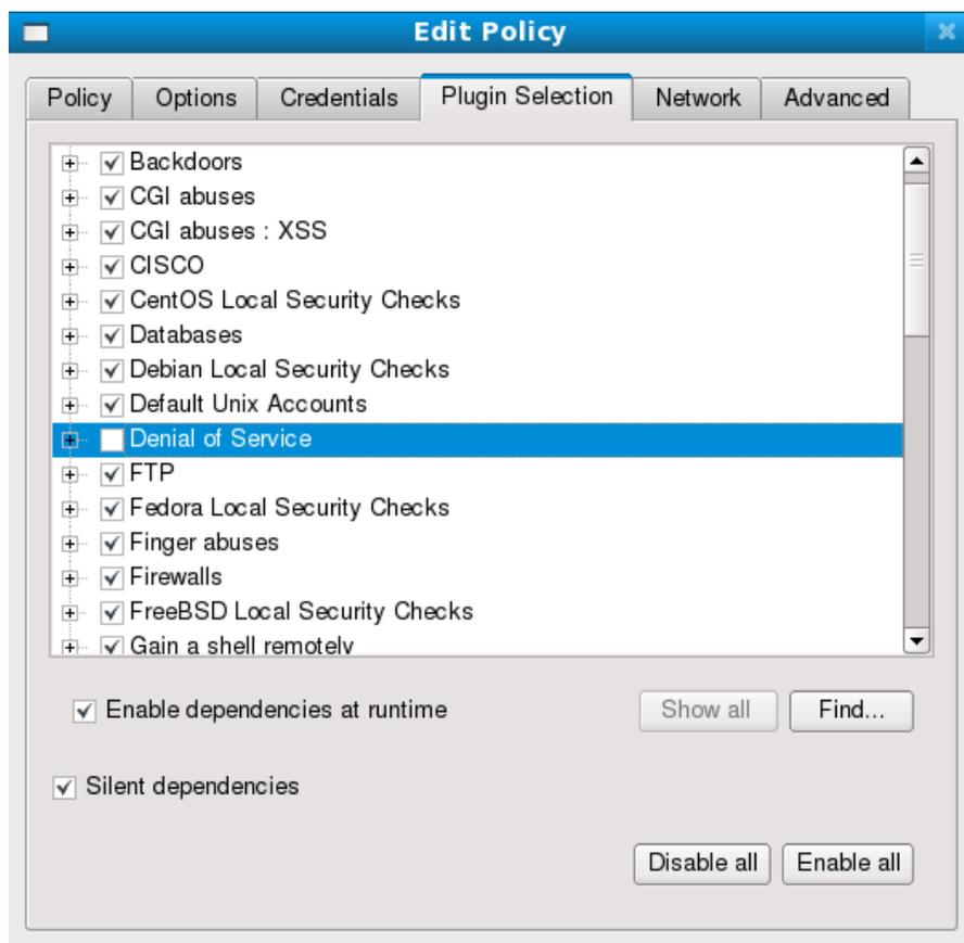
Рис. 19. Отключение DoS проверок («опасных» тестов) в Nessus
