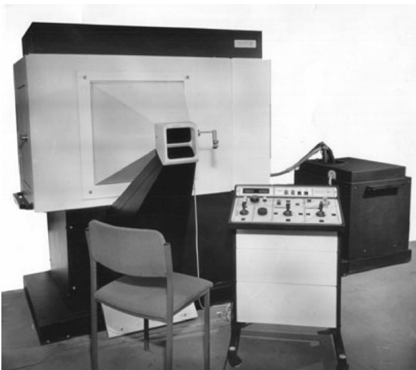
Фото 11. Стационарный двухракурсный флуороскоп «ШИМАЛИТ».
