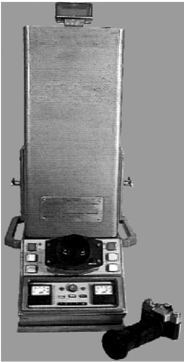
Фото 10. Настольный рентгеновский флуороскоп «ЛОТОС».
