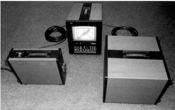
Фото 9. Мобильная рентгенотелевизионная система «РОНА».
